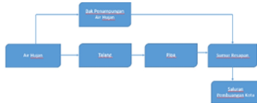
Gambar 3.11 Skema Air Hujan Sumber : Dokumen Pribadi, 2021
