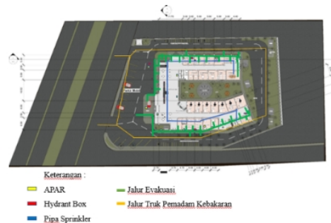
Gambar 3.24 Skema Aplikasi Sistem Penanggulangan Kebakaran Bangunan Klinik Gigi
